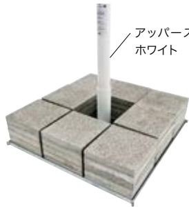
ポータブルスタンドTX Portable Stand TX サイズ／1,250×1,250mm 主材／スチール 重量／43.0kg ●平面でない場所にはご利用できません。 ¥363,000(本体価格 ¥330,000) 別売 スラブ¥176,000(本体価格 ¥160,000) (23.0kg×40枚 要920kg)
