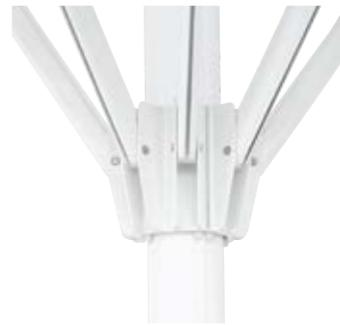
リブ(骨)を支えるランナー部も高強度アルミ製でメインポールの4本の突起レールと噛み合い、ねじれを防ぎます。
